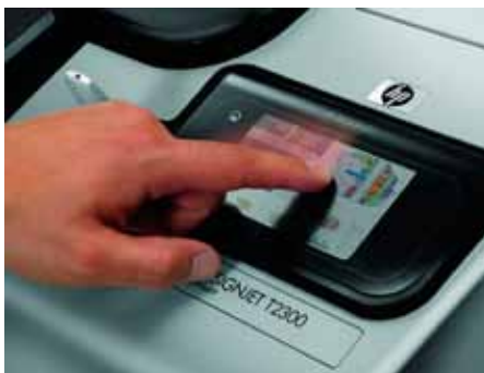
Ein gut lesbares Touch-Display mit klaren Anweisungen, transparenten Menüs und einer Plot-Vorschau vereinfacht den Umgang mit dem Ausgabegerät erheblich (Hewlett-Packard)
